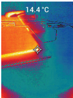
Kuva 5.1 Yhdistetty lämpökuva ja näkyvä kuva (MSX®)
